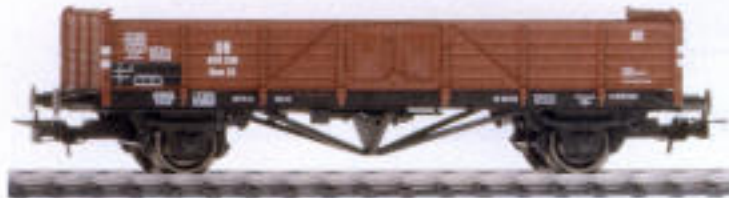
L221601 Offener Güterwagen, DB, Epoche III Omm 805 326. Fahrgestell aus Metall, Kurzkuppungsski- nematik, Kupplungsschacht nach NEM 362, Federpuffer, LÜP 116 mm.
