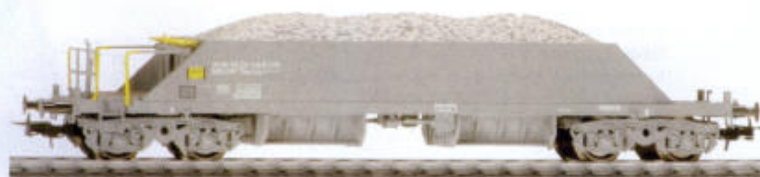
L222304 Neuschotterwagen, SBB, Epoche IV Kurzkupplungskinematik, Kupplungsschacht nach NEM 362, Federpuffer, LÜP 174 mm.
