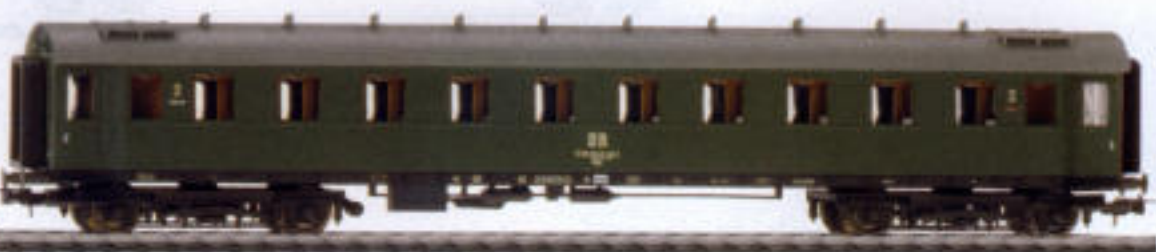
L384392 Eilzugwagen 2. Klasse, DR, Epoche IV Bauart C4ü-28 (um 1970). Inneneinrichtung, Kupplungsaufnahme nach NEM 362, Kurzkupplungskinematik, Federpuffer, LÜP 245 mm.
